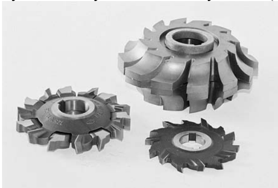
Obr. 5.15. Frézy s priamymi reznými hranami a so striedavým sklonom rezných hrán
