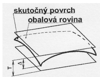
Obrázok č. 5.32, Predpis tolerancie rovinnosti
